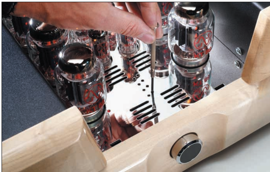
Falls jemals nötig, fällt die Ruhestrom-Neueinstellung leicht: An den Wendel-Trimpotentiometern so lange drehen, bis eine bei der jeweiligen Endröhre angeordnete LED gerade zu leuchten beginnt.
